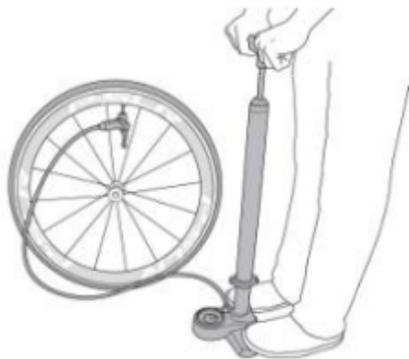
9. Gonflez le pneu à la pression maximale permise par la jante ou le pneu, vérifiez que le pneu se fixe bien dans la jante.
