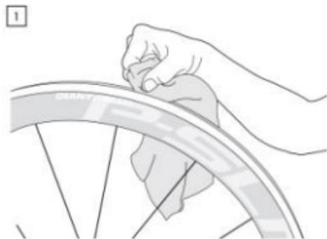
1. Nettoyez et dégraissez la jante. De l'isopropanol à 50% est conseillé.
