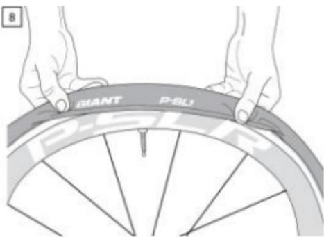
8. Installez le pneu dans la jante. Vérifiez que l'embase du pneu est bien positionnée dans la jante avant de gonfler.
